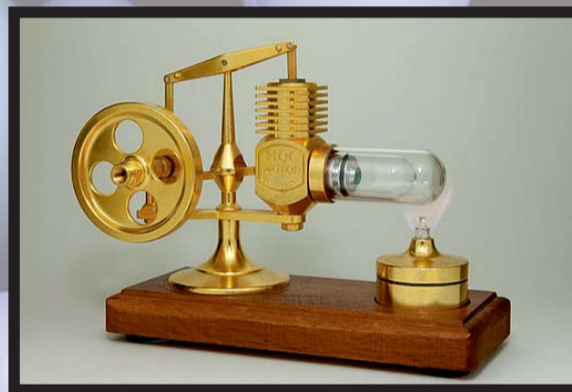
Stirlingmotor: - Über den Carnot-Prozess wird durch Wärme mechanische Arbeit geleistet. https://upload.wikimedia.org/wikipedia/commons/4/42/Stirlingmotor_3.jpg
